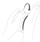
뒷 커버 설치
