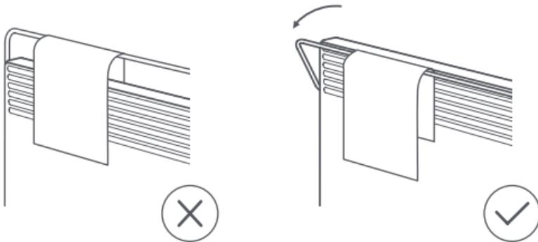
Uwaga: grzejnik należy umieścić na równym podłożu i nie wieszać na suszarce przedmiotów o wadze przekraczającej 1,5 kg.
