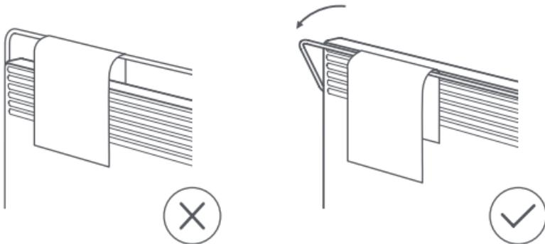
Nota: posizionare il riscaldatore su una superficie piana e non appendere un carico superiore a 1,5 kg sullo stendino.
