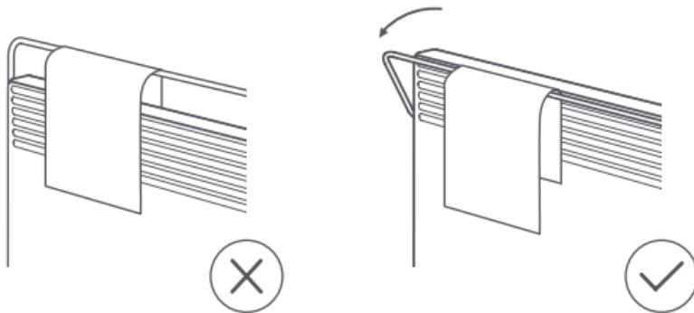
Nota: Coloque o convector ao nível do chão e não pendure uma carga superior a 1,5 kg na grelha de secagem.
