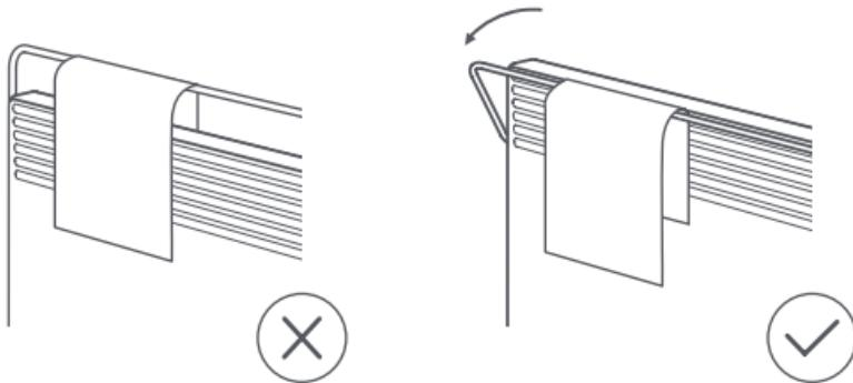
Примечание. Поставьте нагреватель на ровную поверхность и не вешайте на сушилку груз весом более 1,5 кг.
