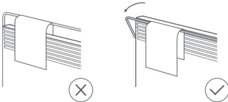
Nota: Coloque el calefactor a nivel del suelo y no cuelgue una carga de más de 1,5 Kg en la rejilla de secado.
