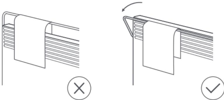
Hinweis: Stellen Sie die Heizung auf eine ebene Fläche und hängen Sie keine Last von mehr als 1,5 kg an das Trockengestell.
